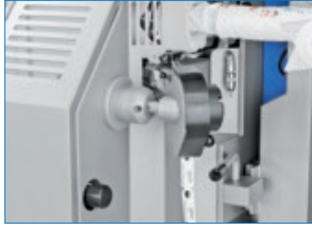
Die Etiketten werden mit dem Printsysteem präzise bedruckt und über den Etikettenspender positionsgenau mit eingeclippt.
