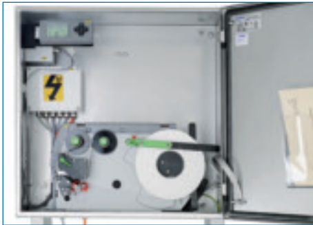
Etiketten und Printsysteem sind in einem hermetisch abgedichteten Edelstahl-Gehäuse eingebaut.
